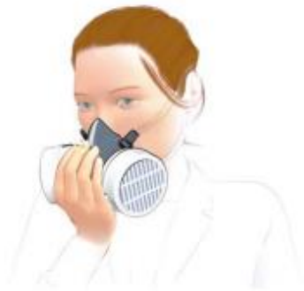
Test d'étanchéité à pression positive
