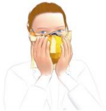
Test d'étanchéité à pression négative
